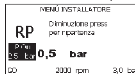
Figura 17: Impostazione della pressione di ripartenza
