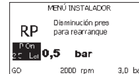
Figura 17: Configuración de la presión de reencendido
