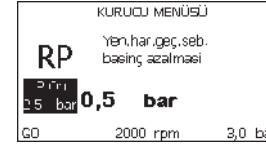
Şekil 17: Yeniden başlatma basıncının ayarlanması
