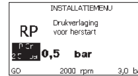
Afb. 17: Instelling van de herstartdruk
