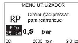
Figura 17: Programação da pressão de rearmar
